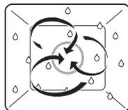
L'air de l'espace de cuisson est chauffé par le corps de chauffe situé derrière la paroi arrière de l'espace de cuisson et circule de façon homogène. Un minimum de vapeur est évacué de l'espace de cuisson. L'humidité de l'aliment à cuire est conservée.
