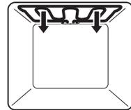
Le chauffage est assuré par le corps de chauffe du gril.
