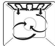
Le chauffage est assuré par le corps de chauffe du gril. L'air de l'espace de cuisson est soufflé uniformément par le ventilateur d'air chaud.
